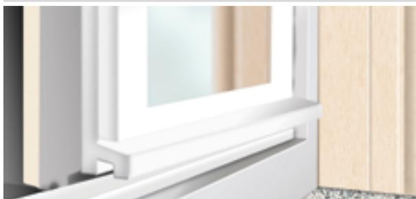
Bei überstehenden Wetterschenkeln ist der Überstand zum Blendrahmenprofil zu ermitteln. Sollte der Überstand den Einsatz keiner aktuellen Spannrahmen-Variante zulassen, kontaktieren Sie uns.
